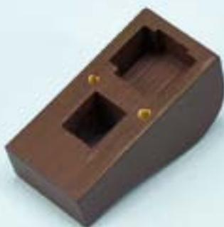
**7** Просверлите два сквозных вертикальных отверстия диаметром 1,2 мм в эзельгофте СМ2, который вы собрали по инструкциям выпуска 80. Прежде чем приступить к работе, внимательно изучите фотографии.
