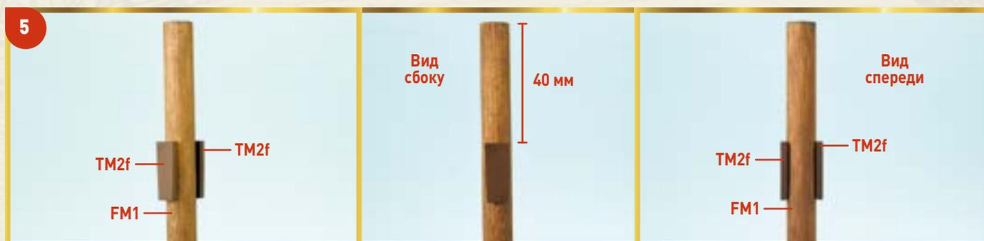
**5** Возьмите две чиксы TM2f, подготовленные по инструкциям выпуска 80, и приклейте их, расположив симметрично, на расстоянии 40 мм от верхнего конца детали FM1 так, как показано на фотографиях.
